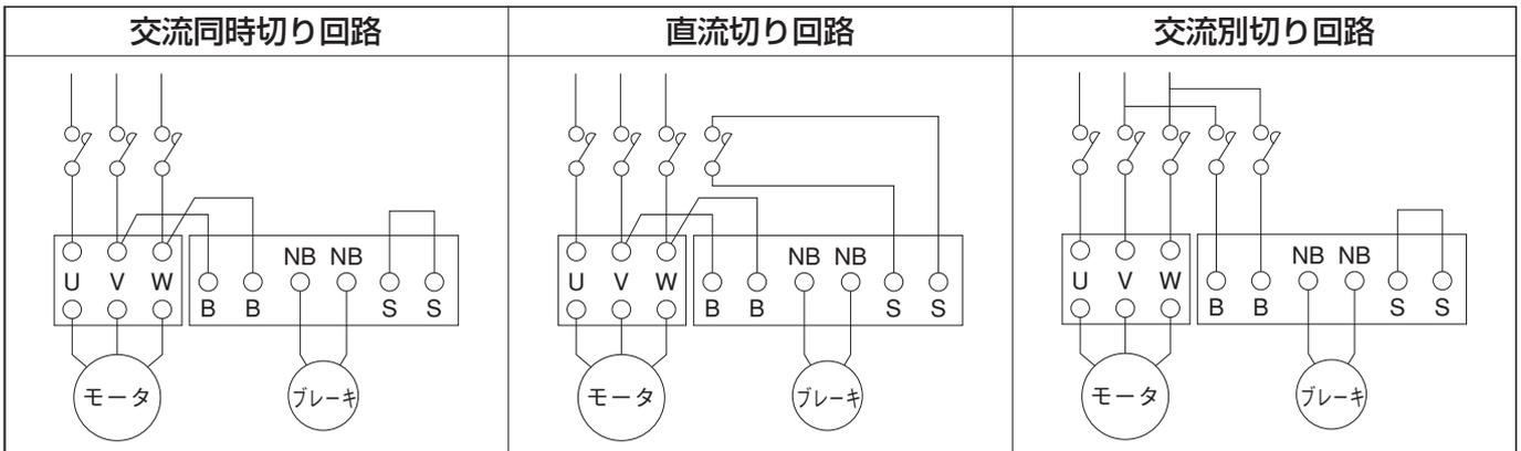
(注)インバータや減電圧始動器をご使用の場合は、ブレーキ又は整流ユニット(パワーモジュール)の一次側をインバータ又は減電圧始動器の電源側に接続してください。
