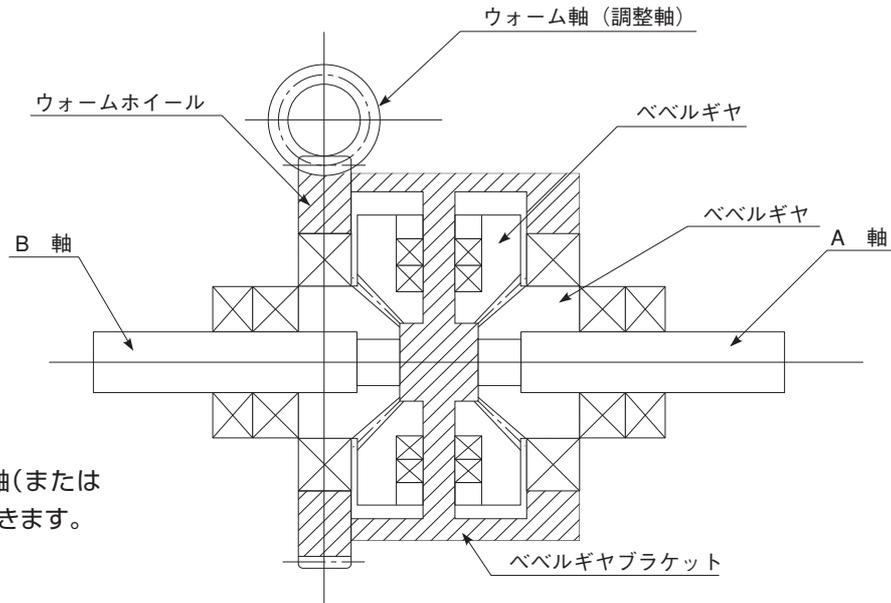
※A軸・B軸とも入力軸(または出力軸)として使用できます。
