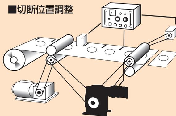
センサで位置を検知して刃物の位相を制御します。
