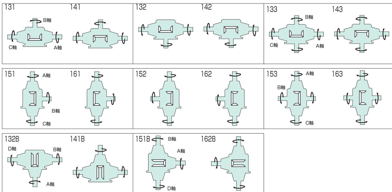
■夕テ形の注油栓、排油栓、油面計の位置はこの軸配置図の紙面手前側に設けています。
